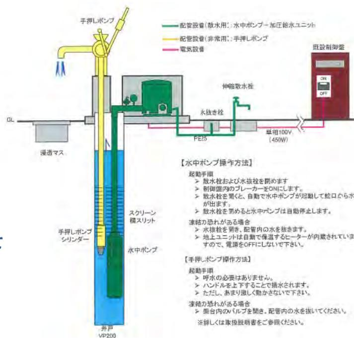
今回、弊社で協力させて頂いた設備は「女川駅前広場コミュニティー井戸」における手押しポンプと電動水中モーターポンプユニットを組み合わせた併設型を設置させていただきました。
